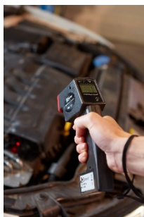
CAP1330 IR thermometer
